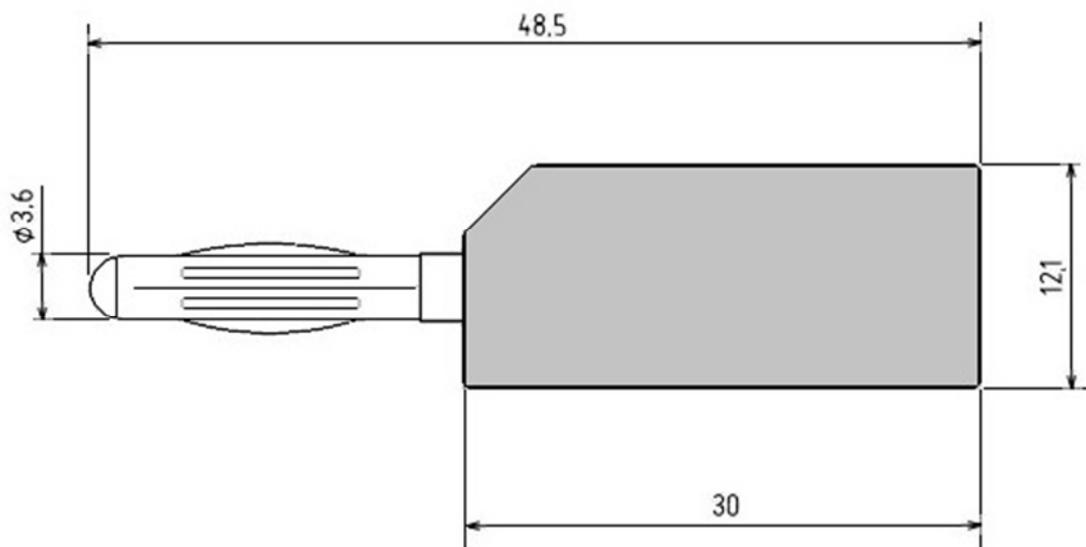
Цвет изолятора может иметь самую разнообразную цветовую гамму. Покрытие контактной части чаще никелированное или позолоченное.
