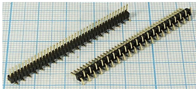
Артикул Q-14087 высота изолятора 2,0мм
