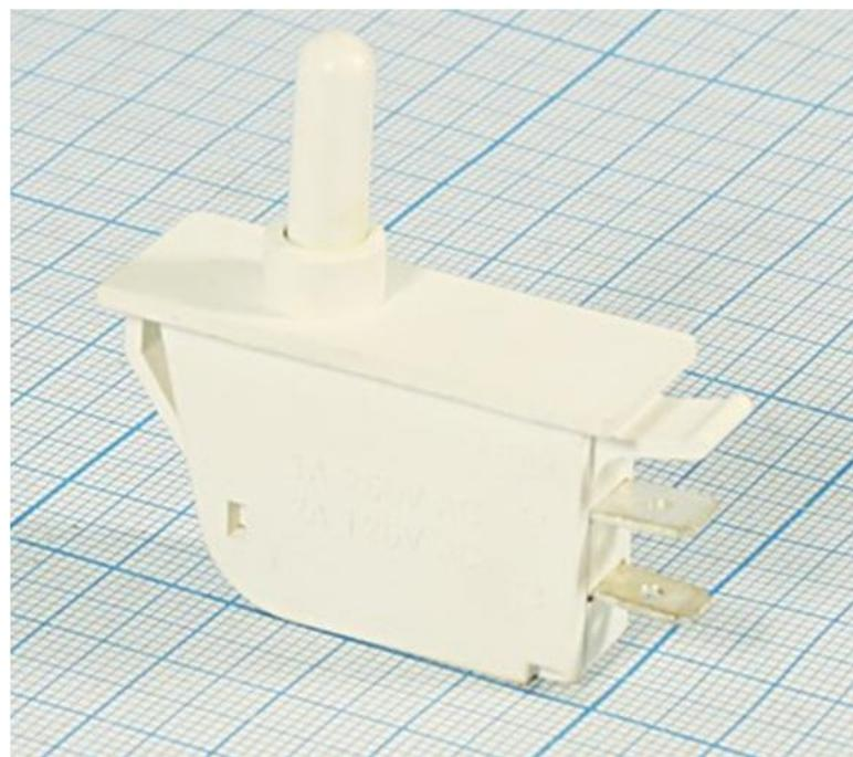
**Переключатель предназначен для коммутации электрических цепей с рабочим напряжением до 250 вольт и током нагрузки до 1 ампера. Основное применение находит в системах сигнализации, где необходимо отслеживать крайнее положение дверей, окон и других конструкций.**
