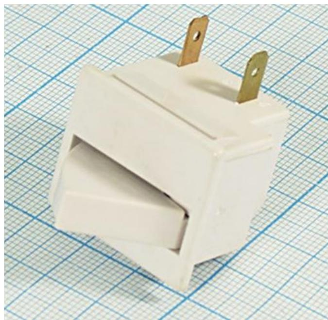
**Переключатель предназначен для коммутации электрических цепей с рабочим напряжением до 250 вольт и током нагрузки до 2,5 ампер. Основное применение находит в системах сигнализации, где необходимо отслеживать крайнее положение дверей, окон и других конструкций.**
