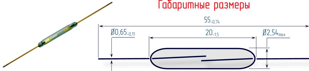
Указаны максимальные значения коммутируемых тока и напряжения. Произведение тока и напряжения рабочего режима не должно превышать значения коммутируемой мощности.
