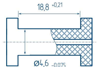
5000 витков, провод Ø 0,063 мм
