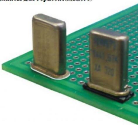
При вертикальном монтаже кварцевый резонатор
