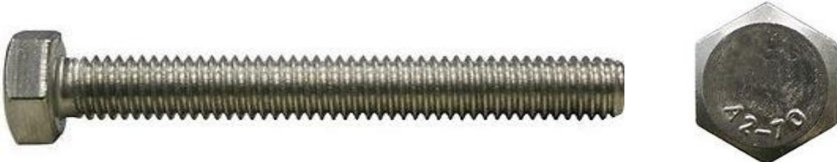
A2 – это сокращенное название марки нержавеющих аустенитных (Austenitic) сталей. Аустенитная сталь обладает рядом замечательных свойств, которые обеспечили ей очень широкое применение в народном хозяйстве. Сталь А2 не токсичны, устойчивы к коррозии. Они хорошо подвергаются механической и термической обработке, а также сварке. Крепежные изделия, изготовленные из стали А2, практически не магнитны, прочны и долговечны. Они отлично сохраняют свои свойства при высоких и низких температурах.
