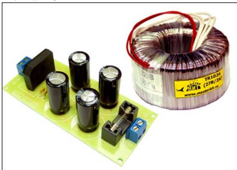
Предлагаемый набор позволит радиолюбителю собрать простой и надежный двуполярный нестабилизированный сетевой источник питания, состоящий из силового тороидального трансформатора, двух блоков выпрямителей с диодным мостом и фильтрующими емкостями. Источник питания найдет применение в составе Вашего усилителя мощности, радиостанции, лабораторного регулируемого блока питания и т.д.
