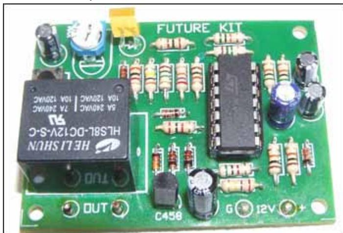
Предлагаемый к сборке набор позволит радиолюбителю собрать устройство, включающее мощную сирену (в комплект поставки не входит) в случае несанкционированного запуска двигателя. Устройство переходит в дежурный режим спустя 10-15 с после постановки на охрану, что позволяет беспрепятственно выйти из автомобиля. Длительность звукового сигнала сирены составляет около 1 минуты, что предохраняет аккумулятор от разряда, а окружающих – от излишнего беспокойства.
