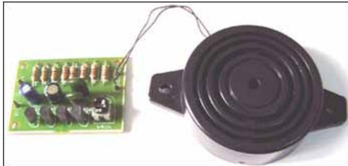
Предлагаемый к сборке набор позволит автолюбителю собрать простое устройство, которое будет издавать прерывистый звуковой сигнал при движении автомобиля задним ходом.
